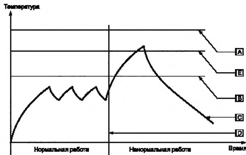
A — опасная температура; B — максимальная температура в ходе нормального использования; C — требуется ручной перезапуск; D — состояние отказа; E — температура термовыключателя
