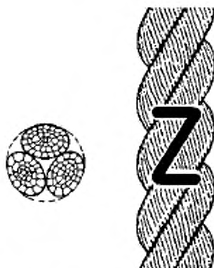
Рисунок 1- Конфигурация 3-рядного крученого каната (тип А)
