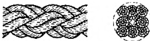
Рисунок 3- Конфигурация 8-рядного плетеного каната (тип L)
