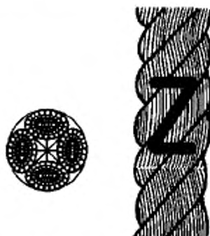
Рисунок 2- Конфигурация 4-рядного крученого каната (тип В)
