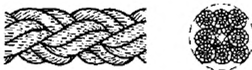
Рисунок 3- Конфигурация 8-рядного плетеного каната (тип L)
