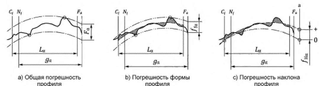
Рисунок 5 — Погрешности профиля с модифицированным углом зацепления
