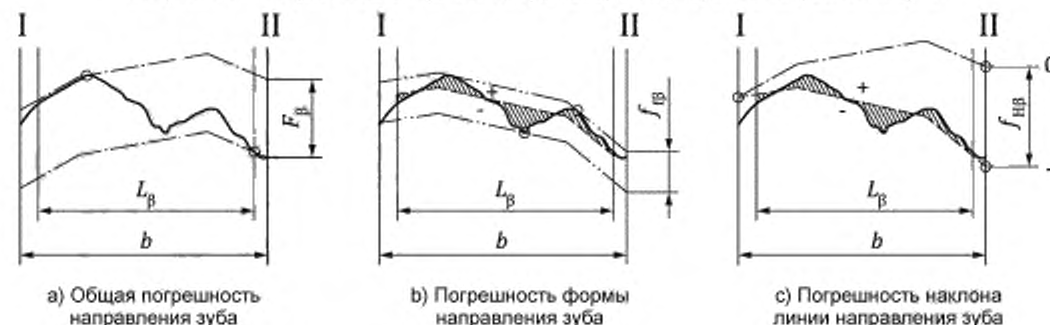
Рисунок 12 — Погрешности направления зуба со срезом у торца по направлению зуба
