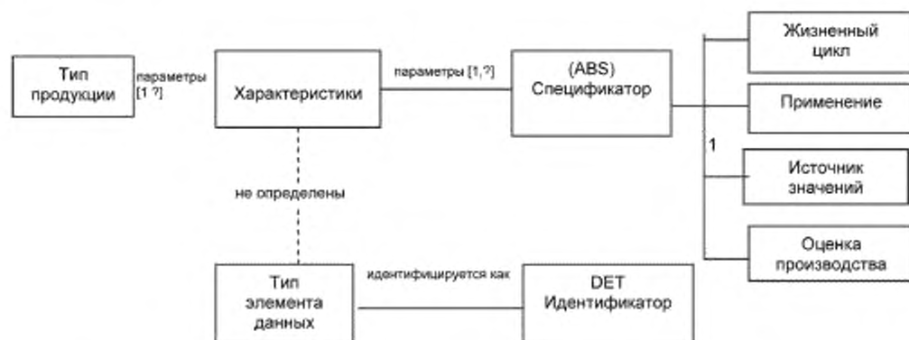
Рисунок 4 — Структура связей между характеристиками типа продукции и типами элементов данных в словаре, который используется для их представления
