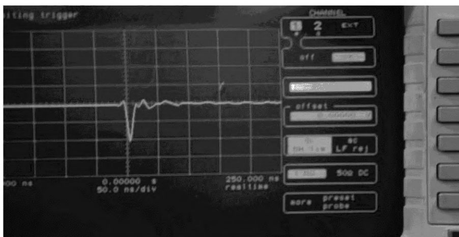
Рисунок 4 — Второй разрядный импульс, который возникает, как показано на рисунке 2
