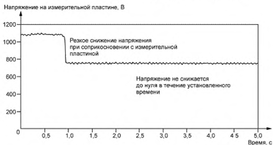
Рисунок 19 — Форма сигнала на пластине
