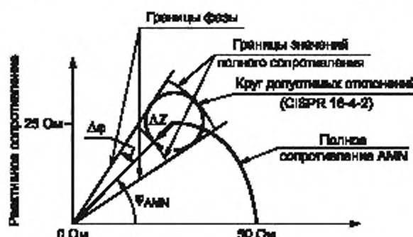
Рисунок I.1 — Определение допустимых отклонений значения и фазы полного сопротивления
