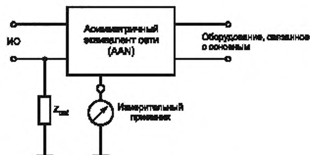
а) Принципиальная схема AAN (или Y-эквивалента) и его порты, включая основной эквивалент с высокой симметрией и (по выбору) несимметричную схему Z_{св}
