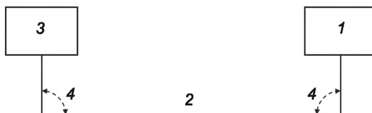
1 — EUT; 2 — испытуемые провода; 3 — имитатор нагрузки; 4 — угол 90^{+45} градусов
