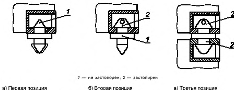
Рисунок А.4 — Полуавтоматический стопор, установленный в верхний угловой фитинг
