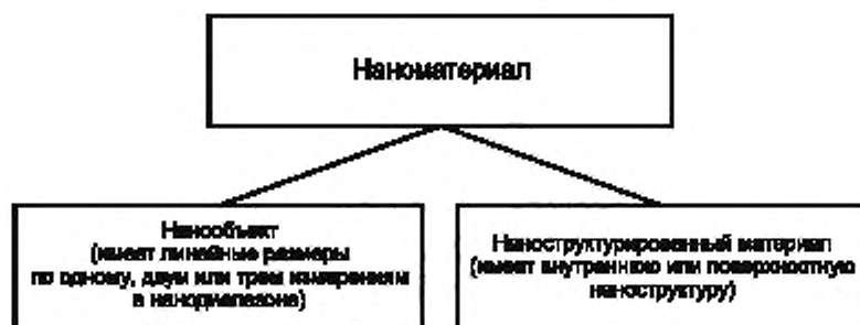
Рисунок 1 — Пример иерархической взаимосвязи определений терминов «наноматериал», «нанобъект» и «наноструктурированный материал»
