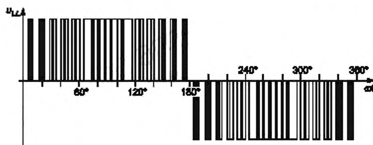
Рисунок 2 — Форма линейного напряжения u_{LL} при питании от инвертора напряжения с частотой коммутации f_s = 30f_1
