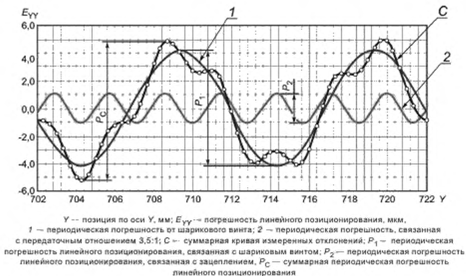
Рисунок С.2 — Пример периодической погрешности линейного позиционирования для оси Y с шариковым винтом с шагом 10 мм, электроприводом с передаточным отношением 3,5:1 и угловым преобразователем на валу электродвигателя
