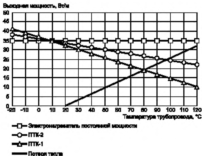
Рисунок 3 — Условия равновесия для поддержания температуры в трубопроводе
