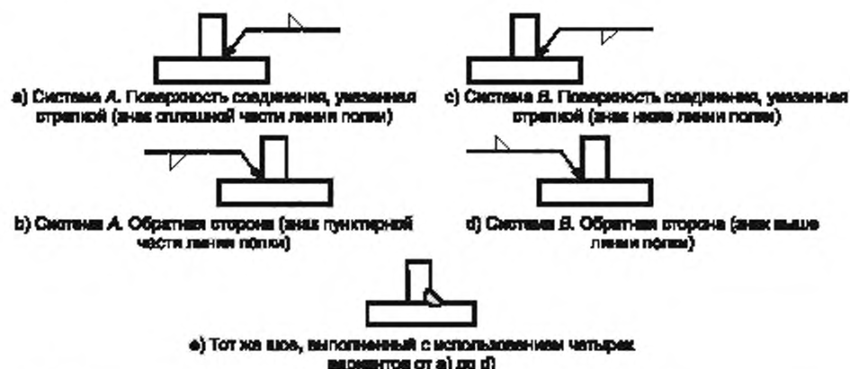
Рисунок 5 — Примеры обозначений сварного соединения для поверхности соединения указанной стрелкой и обратной стороны
