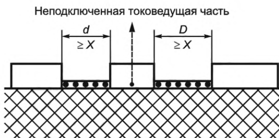
Рисунок ВВ.7 — Нецементированный стык с узкой и широкой канавками
