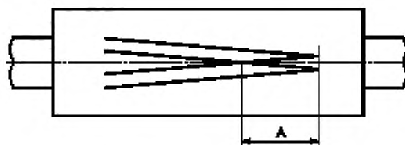
Рисунок GG.4 — Измерение амплитуды вибрации
