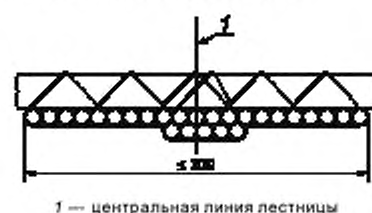
Рисунок 2 — Кабели, закрепленные на передней стороне широкой лестницы с зазором
