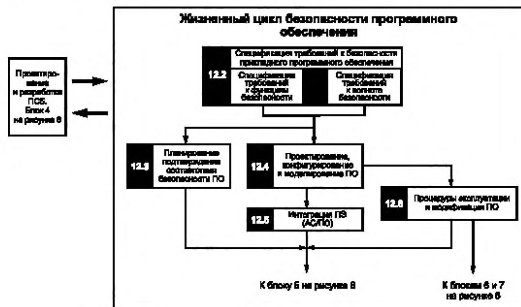
Рисунок 11 — Жизненный цикл безопасности прикладного ПО (стадия реализации)
