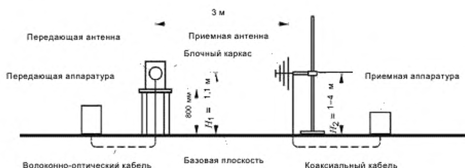
Рисунок 5 – Установка для измерения рассеяния силы сигнала поля E2 (блочный каркас) 3.5.3 Полубезэховые или полностью безэховые камеры
