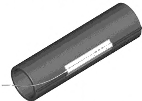
Рисунок F.2 — Датчик ограничителя температуры на оболочке электронагревателя
