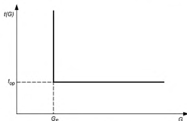
Рисунок 2 — Независимая характеристика времени реле сверхтока
