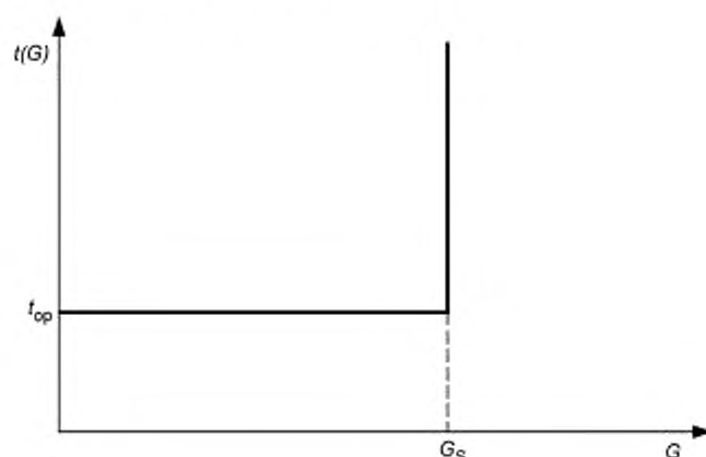
Рисунок 3 — Независимая характеристика времени реле минимального тока
