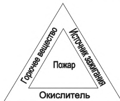
Рисунок 2 — Возникновение пожарной опасности
