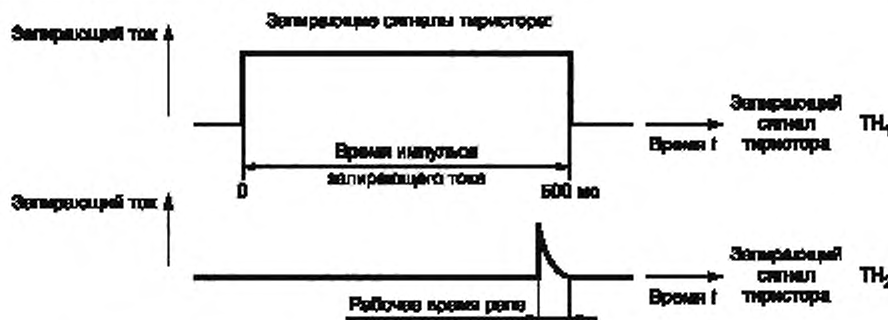
Рисунок G.2 — Схема создания и применения импульсов большой длительности
