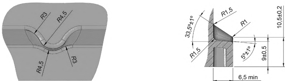
а) Форма и размеры выемки (деталь X) на бортике батареи б) Форма и размеры деталей бортика (вертикальные разрезы R-R и T-T)
