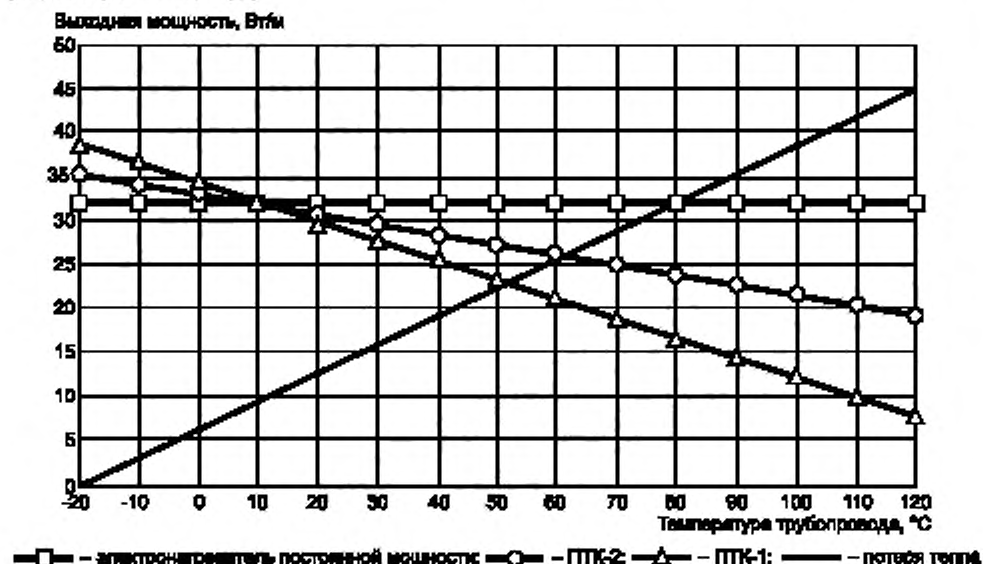
Рисунок 3 — Условия равновесия для поддержания температуры в трубопроводе
