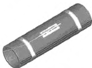
Рисунок 7 — Типичная установка датчика системы управления и датчика термореле
