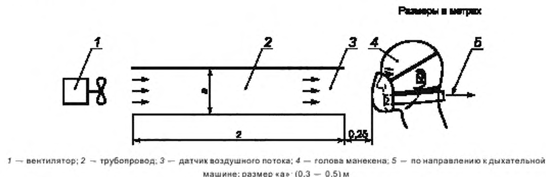
Рисунок 7 — Схема проведения испытания по определению содержания диоксида углерода
