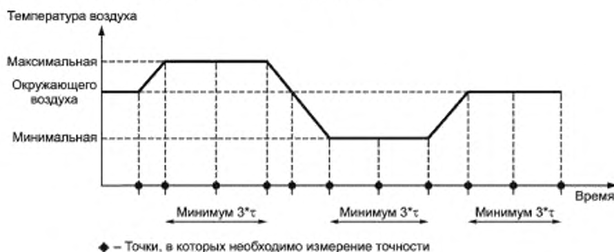
Рисунок 16 — Температурные циклы для проверки класса точности
