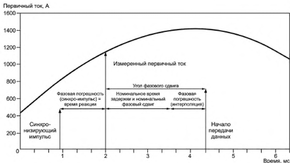
Рисунок В.4 — Определение фазовой погрешности для цифрового интерфейса
