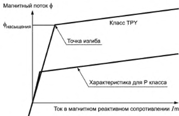
Рисунок А.7 — Магнитное реактивное сопротивление ЭТТ для ТРУ класса
