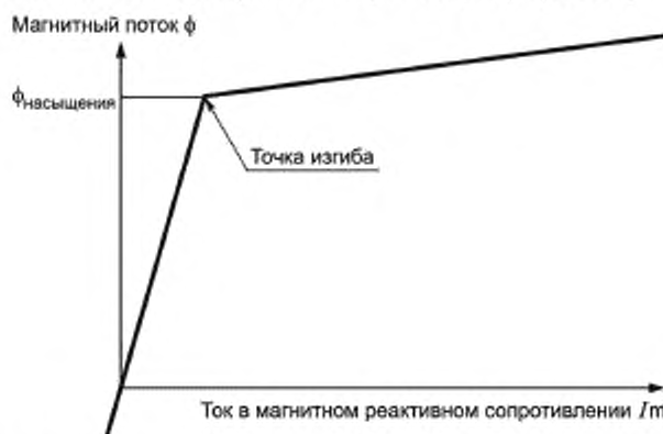
Рисунок А.4 — Магнитное реактивное сопротивление ЭТТ без остаточного магнетизма
