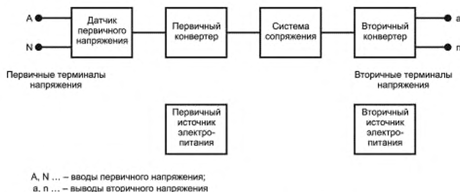
Рисунок 1 — Блок-схема заземляемого однофазного ЭТН
