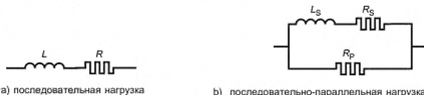
Рисунок А.1 — Схемы цепей индуктивной нагрузки при определении параметров переходных характеристик
