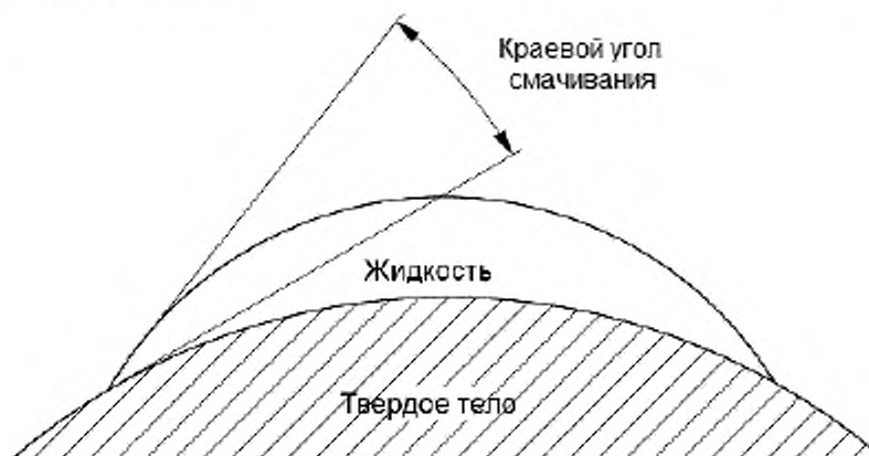
Рисунок 1 — Схематичное изображение краевого угла смачивания
