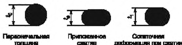
Рисунок 6 — Остаточная деформация при сжатии уплотнительного кольца
