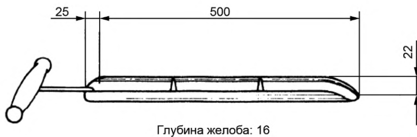
Рисунок А.3 — Секционный пробоотборный щуп (открытый триер)
