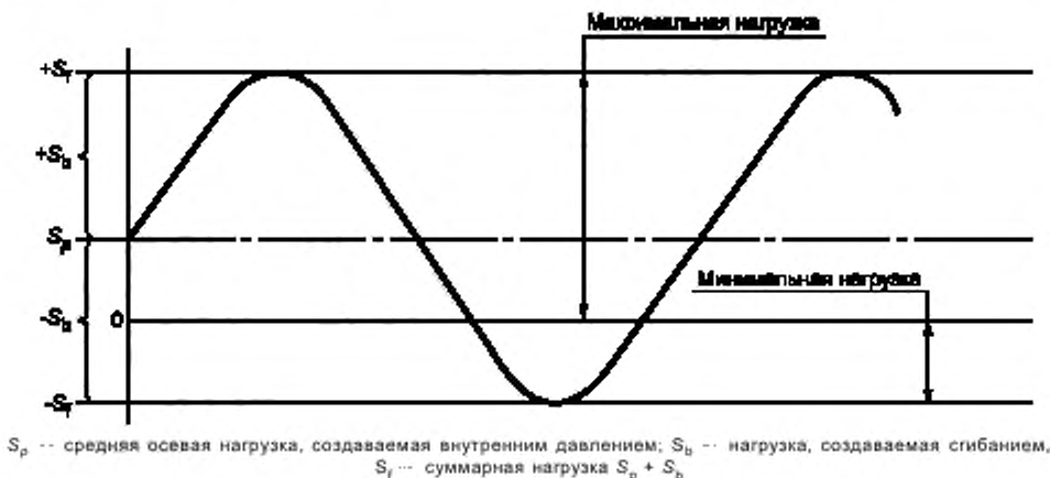
Рисунок 4 — Стандартный цикл переменной нагрузки при внутреннем давлении
