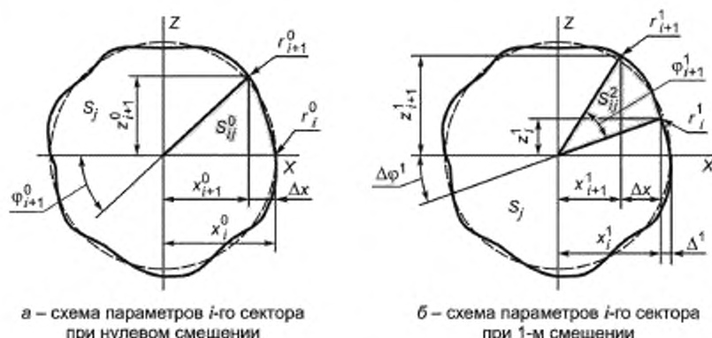
Рисунок И.5 — Схема параметров в j -м сечении
