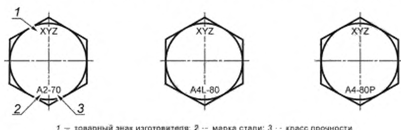
Рисунок 2 — Маркировка болтов и винтов с шестигранной головкой
