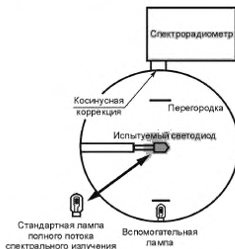
Рисунок 4 — Оптическая схема измерений в режиме полного потока
