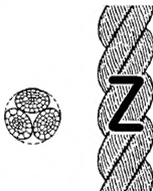
Рисунок 1- Конфигурация 3-прядного крученого каната (тип А)
