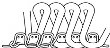
Рисунок 17 — Осново-вязанный ворсовый ковер (продольное сечение)
