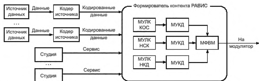
Рисунок 2 — Система формирования контента РАВИС
