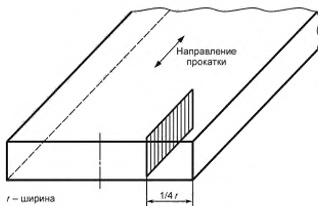
Рисунок 4 — Образец от листа толщиной не более 25 мм
