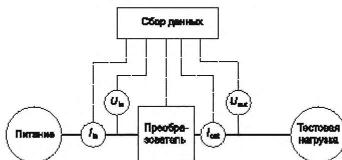
Рисунок 19 — Определение потерь в преобразователе методом вход-выход
