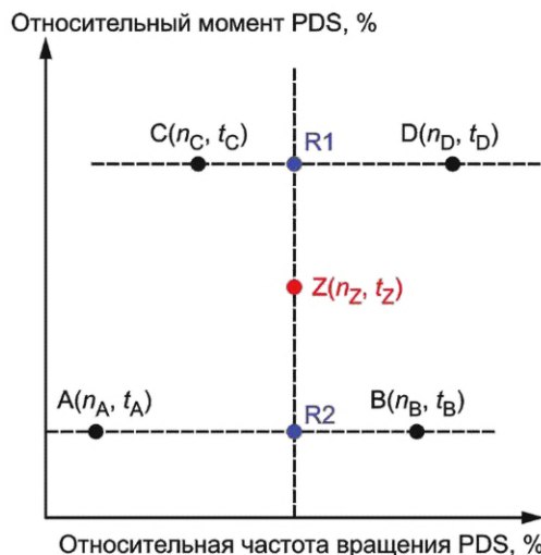
Рисунок 8 — Двухкоординатная интерполяция в окрестности опорных точек
