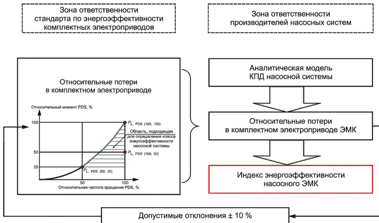
Рисунок А.2 — Пример совместного использования квазианалитических моделей комплектного преобразователя и насосной системы для оценки индекса энергоэффективности насосного ЭМК
