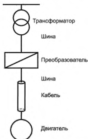
Рисунок Е.3 — Пример электрического привода
