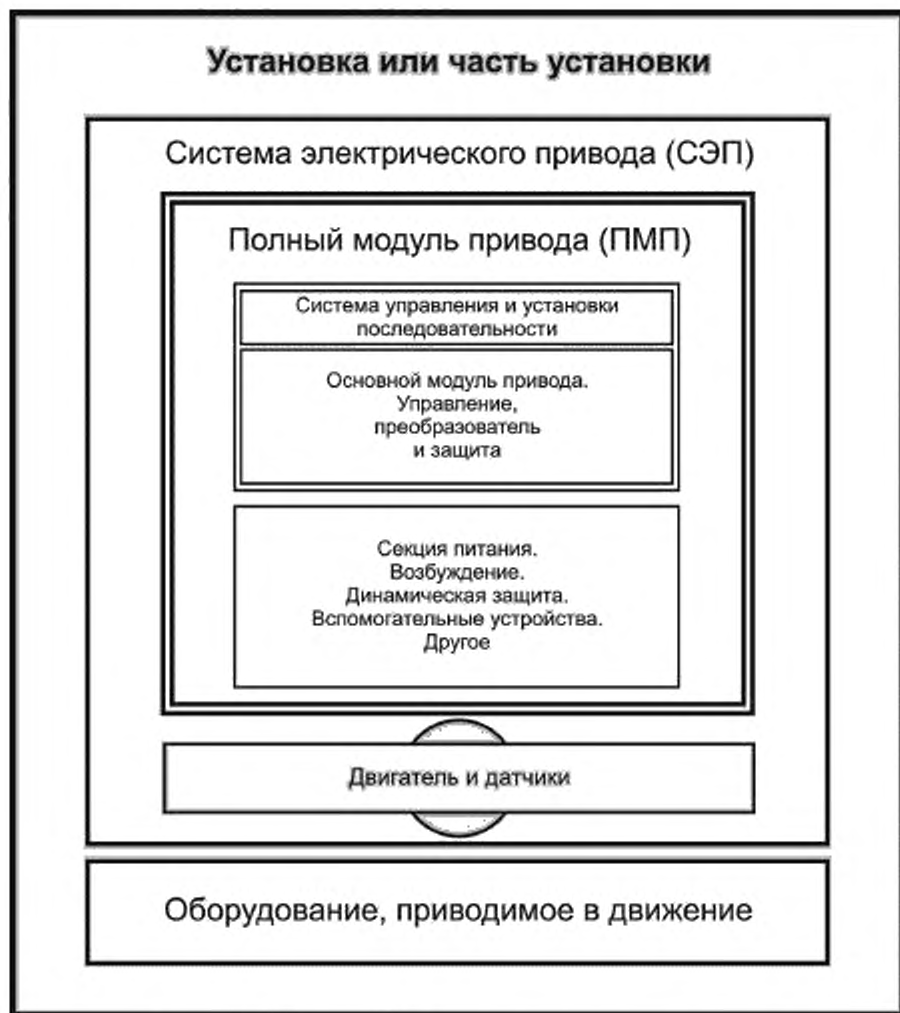
Рисунок 1 — Определения, относящиеся к установке и ее составу
