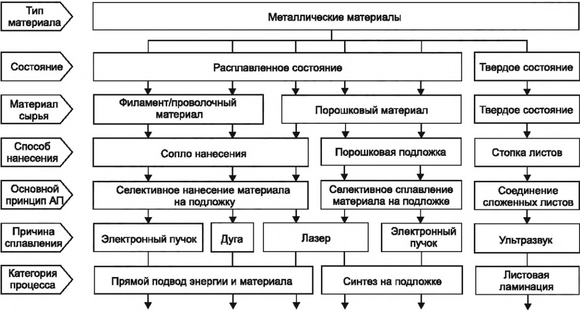
Рисунок В.2 — Обзор одношаговых аддитивных технологических процессов для металлических материалов
