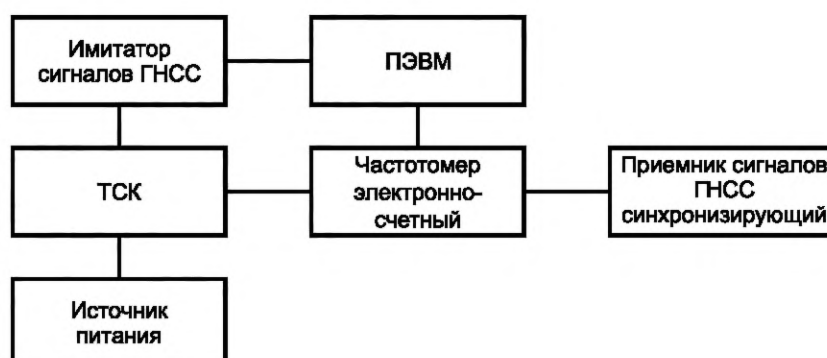
Рисунок А.2 — Схема соединений испытательного стенда для определения погрешности синхронизации внутренней шкалы времени навигационного модуля ТСК с национальной шкалой координированного времени UTC (SU)
