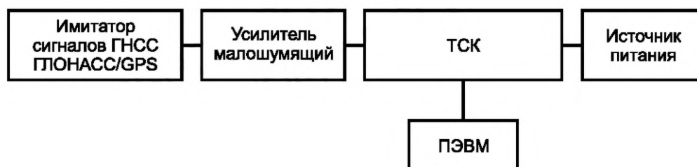
Рисунок А.1 — Схема испытательного стенда для проверки работоспособности ТСК
