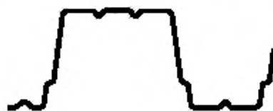
Рисунок 3 — Профили с элементами жесткости на полках и стенках
