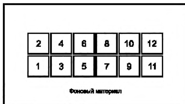
Рисунок А.5 — Пример тест-таблицы для испытания на передачу серой шкалы
