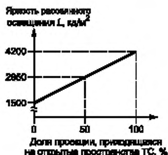
Рисунок 3 — График для определения значения яркости для рассеянного источника света
