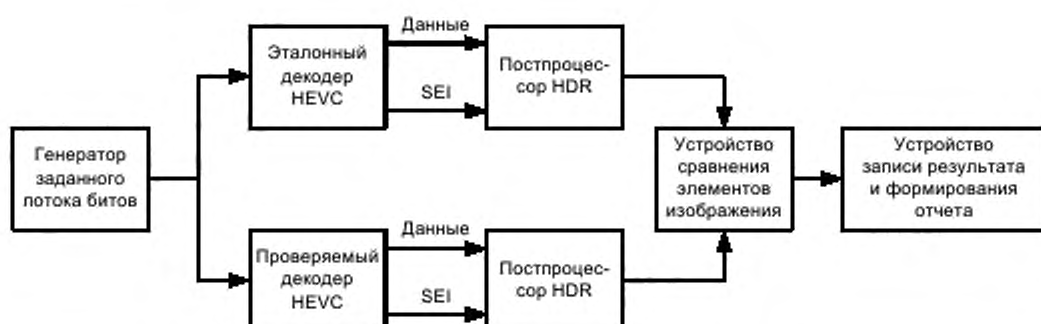
Рисунок 4 — Схема измерения декодеров формата HEVC/HDR и HEVC/HDR/HFR с объективной оценкой соответствия
