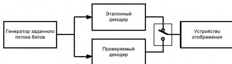
Рисунок 2 — Схема измерения с визуальным сравнением изображений
