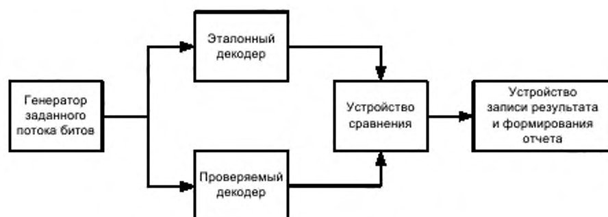
Рисунок 3 — Схема измерения с объективной оценкой соответствия
