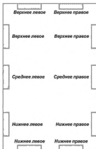
Рисунок 11 — Расположение мест на лицевом и/или тыльном покрытиях для проведения испытания на отслаивание
