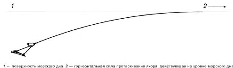
Рисунок А.24 — Схема конфигурации якорной линии при заглаблении в грунт
